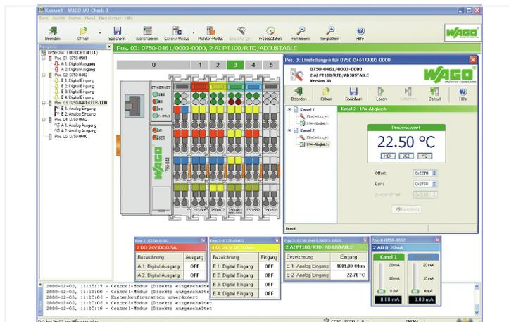
WAGO-I/O-CHECK é uma aplicação Windows fácil de usar para verificar entradas e saídas e exibir um nó I/O System 750 da WAGO.
