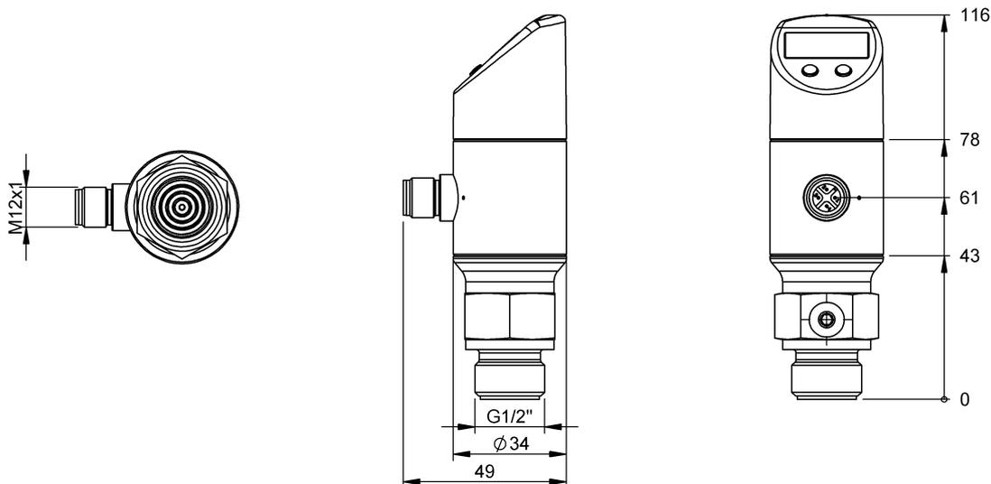
1) Painel de indicação e de comando, 2) Conexão de processo, 3) Invólucro giratório em 320°
