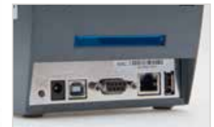
Impressora possui diversas interfaces:USB, RS-232, ETHERNET 10/100 Mbps, USB Host
