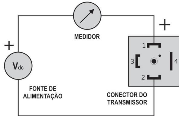
Fig. 2 – Conexões elétricas
