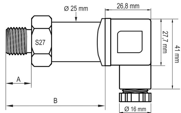
Fig. 3 – Dimensões do transmissor
