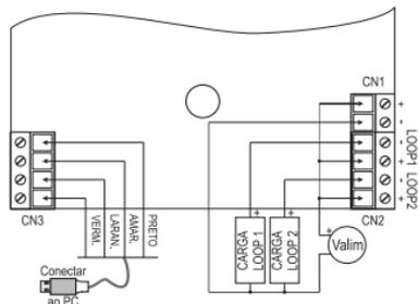
Para configuração com o D201, não há necessidade de conexão dos conectores CN1 e CN2.
